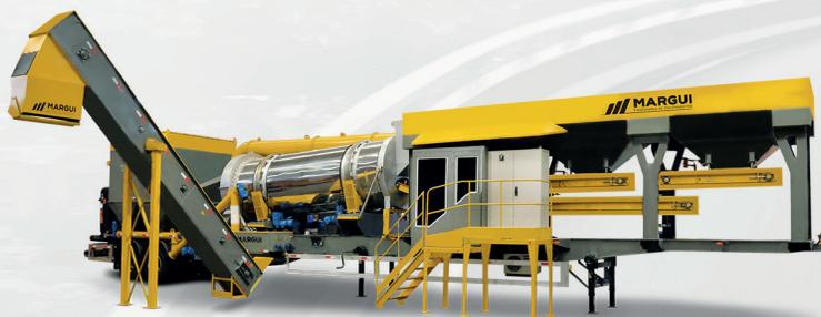
Planta de Asfalto 40 a 60 t/h
